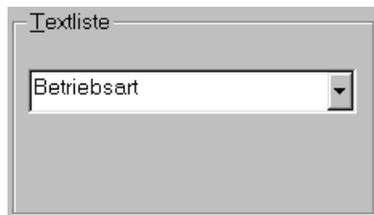
Falls noch keine Textliste erzeugt wurde, kann an dieser Stelle bereits der Name der Textliste eingegeben werden. Die erzeugte Textliste ist allerdings noch leer. Die Zuordnung zwischen Text und Steuerungswert wird innerhalb der Textliste vorgenommen.
