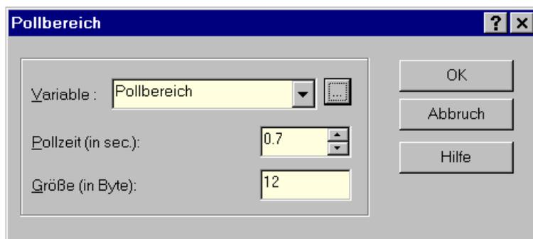
Der serielle Meldekanal wird auch zum SPS-gesteuerten Maskenaufruf verwendet. Wenn eine Maske und eine Meldung mit gleicher Nummer existieren wird beim externen Maskenaufruf nicht nur die entsprechende Maske aufgerufen sondern gleichzeitig auch die Meldung in den seriellen Meldespeicher eingetragen.
