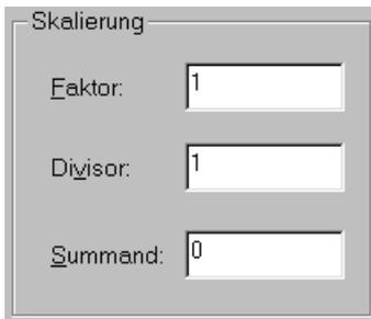
Ein Steuerungswert wird vor der Ausgabe mit dem Faktor multipliziert, mit dem Divisor dividiert und mit dem Summand vorzeichenabhängig addiert oder subtrahiert. Dies ermöglicht die Anpassung zwischen Wertebereich in der Steuerung und Ausgabebereich am Bedienterminal (Berechnung der Skalierungswerte siehe Anhang).
